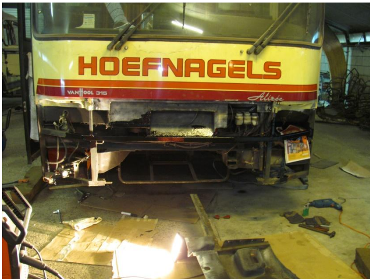
Bus met half front maar met vervangen kokerbalk in het midden
