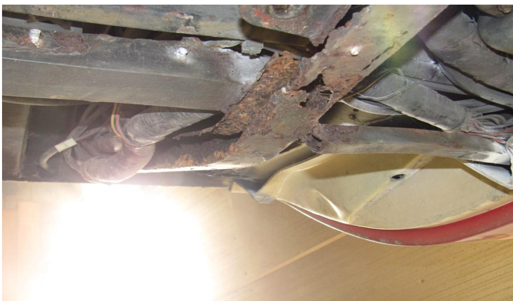
Bus met half front maar met vervangen kokerbalk in het midden
